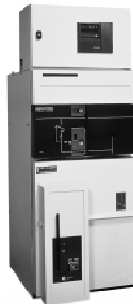
Fig. 4: Un ejemplo de aplicación de la CEM: una celda MT «SM6» integra un interruptor automático que corta cientos de amperios a decenas de kilovoltios, y una unidad programable SEPAM de protección y de control y mando. El conjunto debe de estar siempre operativo bajo cualquier circunstancia.
