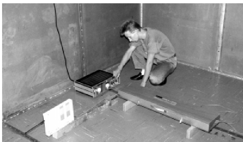
Fig. 28: Medida de inmunidad a los transitorios rápidos de una central Isis (test 61000-4-4) en una caja de Faraday. En esta foto se ven: el generador de perturbación manipulado por el operador, la maleta de madera que contiene la pinza de acoplamiento y la central Isis (a la derecha) enchufada a la red BatiBUS.
